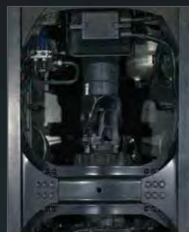
Карданный вал из высокопрочного алюминиевого сплава
