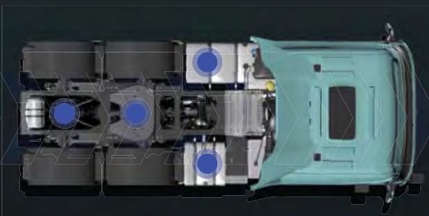
Широкое использование литых деталей в крупных узлах и механизмах
